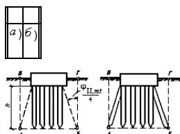
Определение границ условного фундамента при расчете осадок свайных фундаментов
